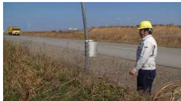
降下ばいじん量の監視
