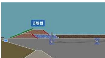
2段目の土堰堤を築造し、あとは同じ作業を12段まで繰り返す
