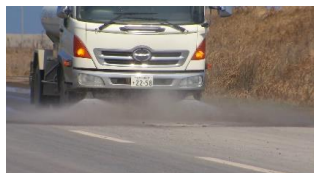
散水作業の様子
