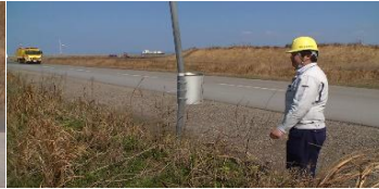
降下ばいじん量の監視
